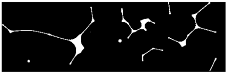
图 13 二值腐蚀处理(半径为 1 的圆形结构元素) Fig. 13 Eroded by circle structure element which radius=1
